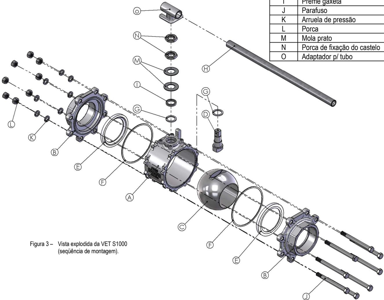
Figura 3 – Vista explodida da VET S1000 (seqüência de montagem).
