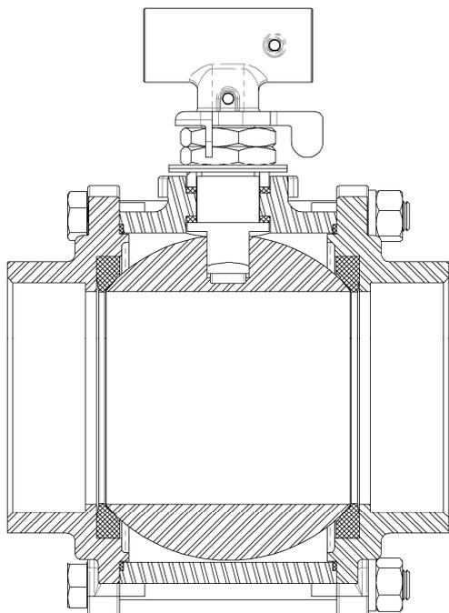
Figura 1 – Corte transversal da VET S1000 Cl. 300 Montada.
