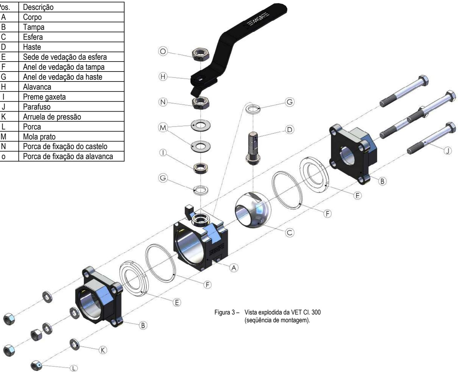
Figura 3 – Vista explodida da VET Cl. 300 (seqüência de montagem).
