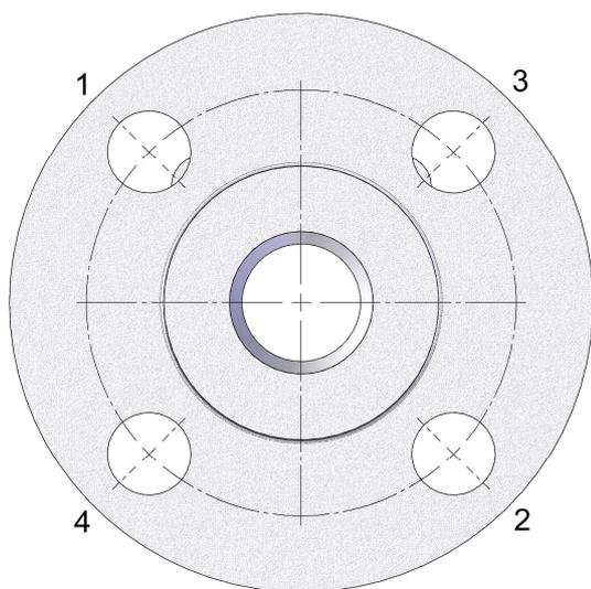
Figura3 – Sequência de aperto dos parafusos Flange Classe 150.
