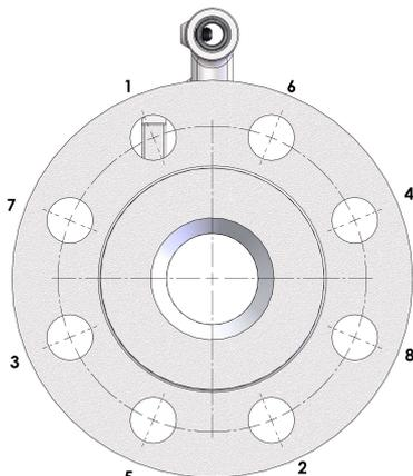
Figura2 – Sequência de aperto dos parafusos Flange Classe 300
