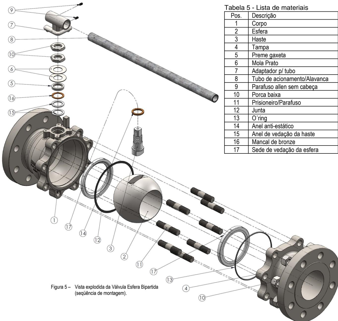
Figura 5 – Vista explodida da Válvula Esfera Bipartida (seqüência de montagem).
