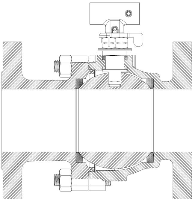
Figura 2 – Corte transversal da Válvula Esfera Bipartida Montada.
