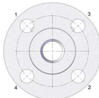
Figura 3 – Sequência de aperto dos parafusos do flange.
