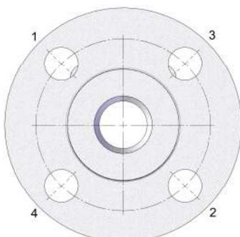
Figura2 – Seqüência de aperto dos fixadores do Flange.
