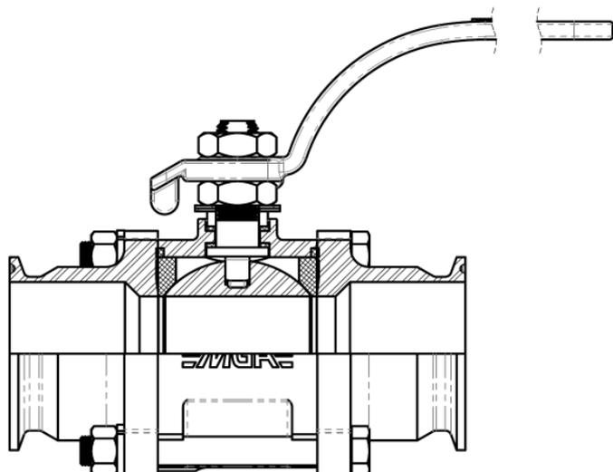
Figura 1 – Corte transversal válvula Montada com conexão TC.
